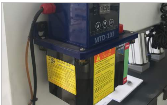
Hệ thống bơm nhớt tự động bảo vệ máy
