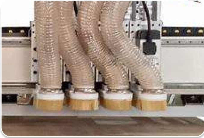
Đầu Router khoan, cắt, chạy rãnh
