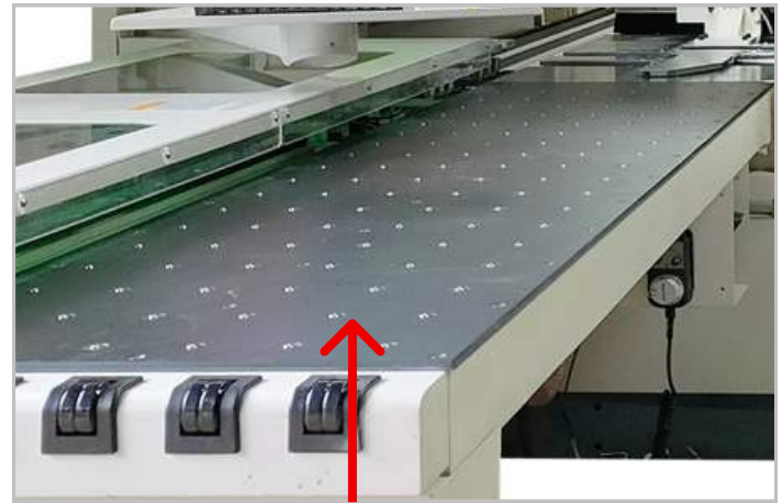
Hệ thống bàn thổi hơi
