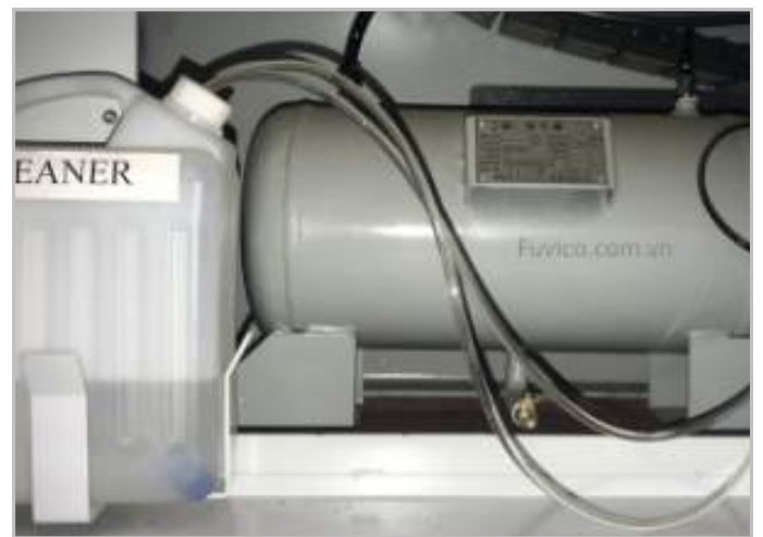
Máy có bình tích khí giúp ổn định áp suất khí nén
