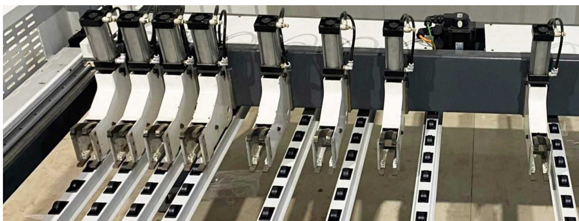
Hệ thống kẹp phôi dày max 100 mm
