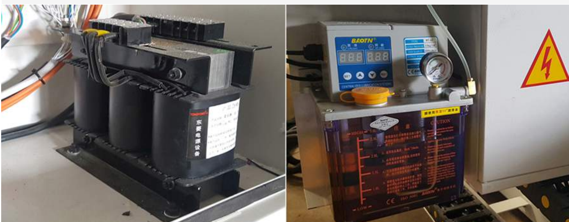
Biến áp bảo vệ dòng điện - Bơm nhớt tự động bảo vệ ray trượt
