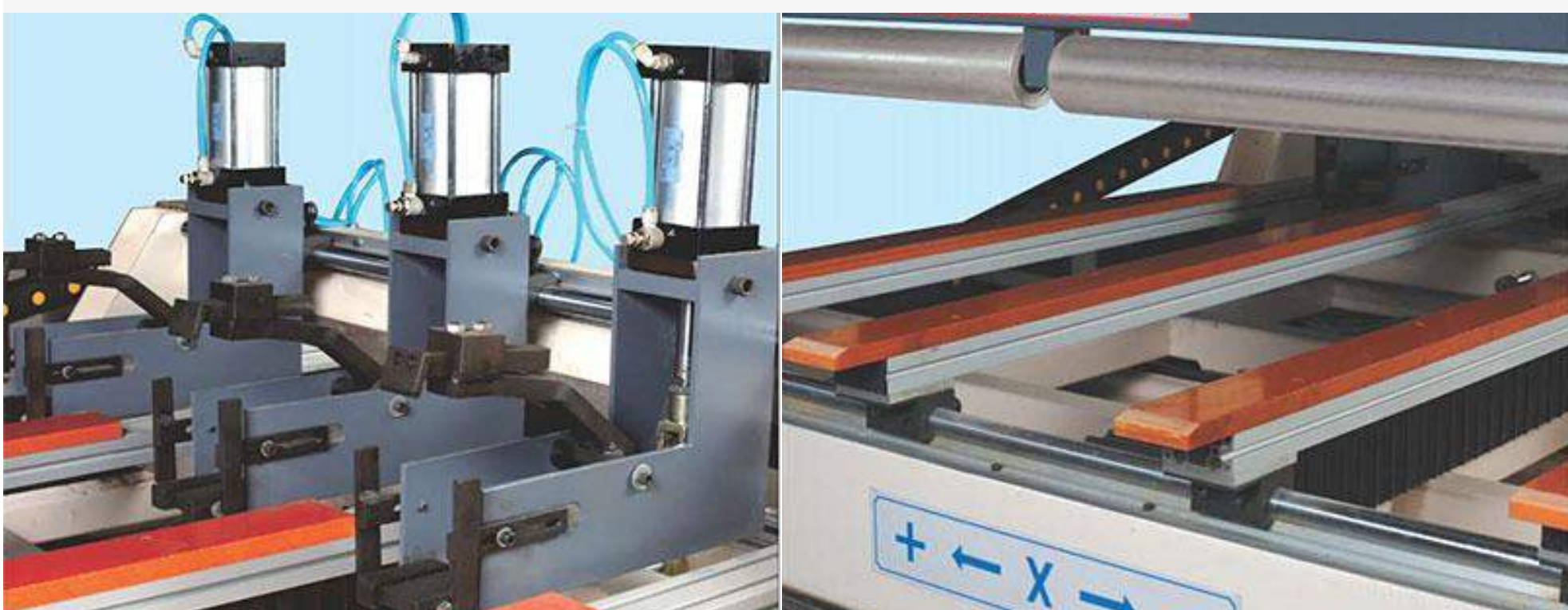
Hệ thống kẹp, tì phôi bằng khí nén
