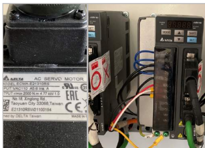
Hệ thống servo, driver: Delta Đài Loan
