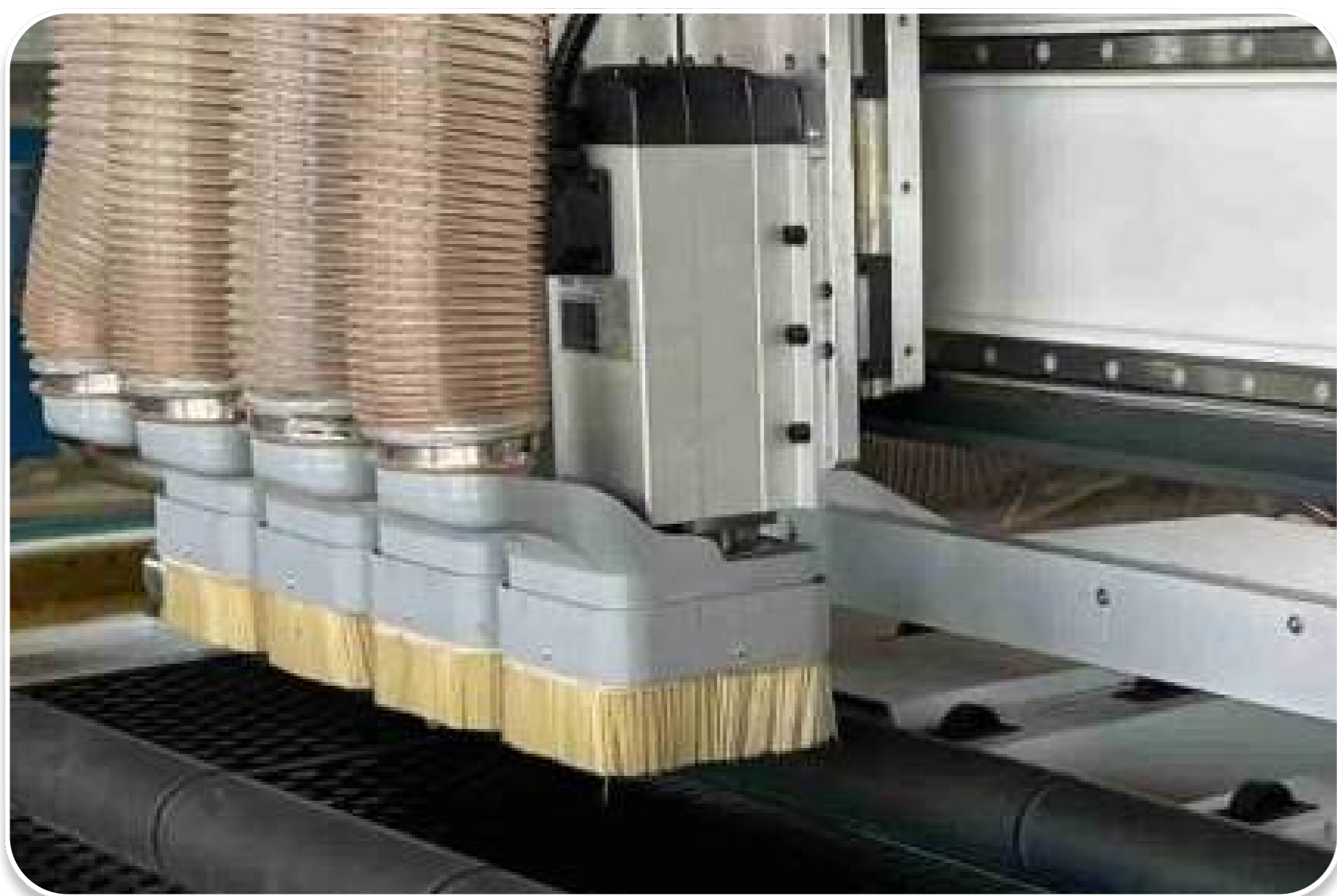
Công suất đầu Router: 6Kw x 4pcs
