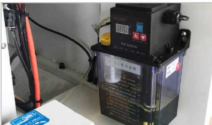
Hệ thống bơm nhớt tự động bảo vệ máy
